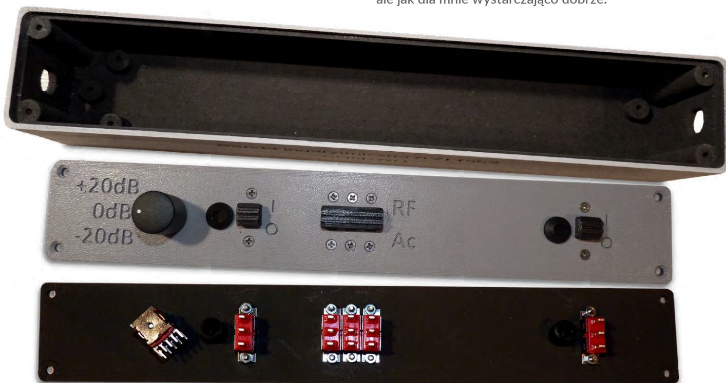
Obudowa po pomalowaniu z zamontowanymi przełącznikami.
